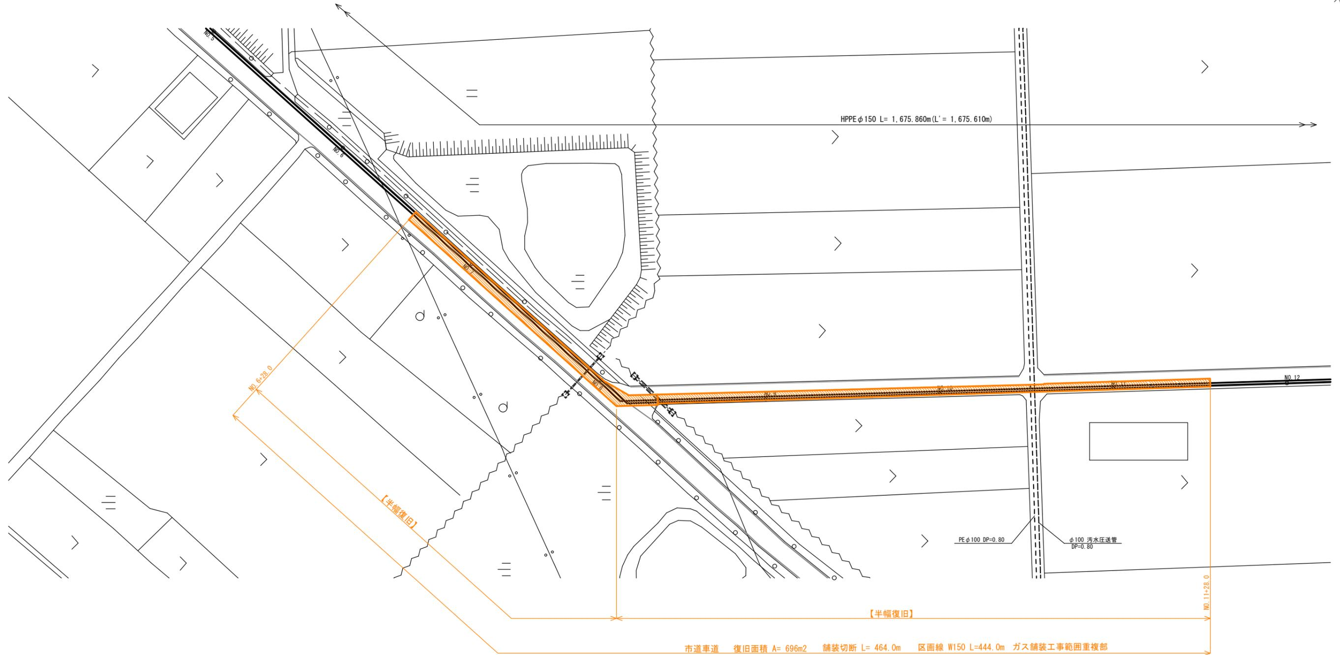
市道車道 復旧面積 A= 696m<sup>2</sup> 舗装切断 L= 464.0m 区画線 W150 L=444.0m ガス舗装工事範囲重複部
