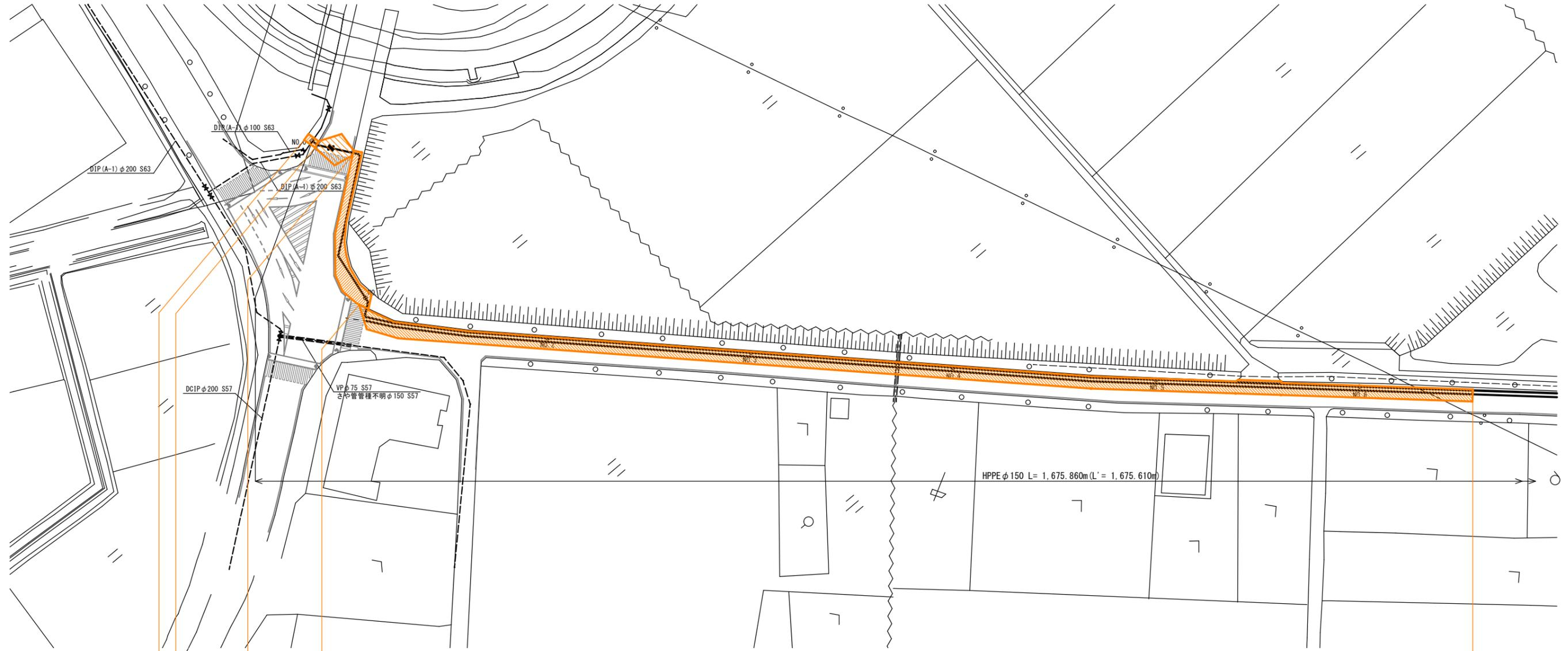
県道歩道 舗装切断 L= 6.4m 復旧面積 A= 5.7m<sup>2</sup>
